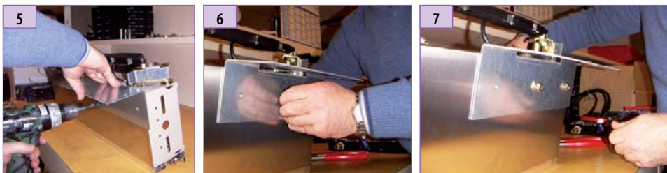
Positionner les supports serrure puis contre-percer ( \varnothing 4 + \varnothing 10 )
